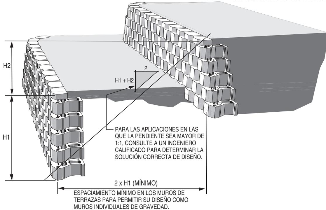
Un área de diseño que afecta a muchas aplicaciones es el uso de muros con terraza. El muro de la terraza superior puede agregar presión a la terraza más baja, si los muros están demasiado cercanos. Los muros múltiples con terraza pueden crear problemas de estabilidad estructural, ya que los muros inferiores pueden no tener la capacidad para soportar las cargas desarrolladas por los muros superiores.
